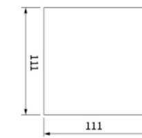
外形尺寸: 120x120mm 开孔尺寸: 111x111mm
