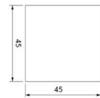
外形尺寸: 48x48mm 开孔尺寸: 45x45mm
