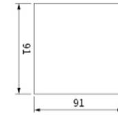
外形尺寸: 96x96mm 开孔尺寸: 91x91mm
