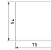
外形尺寸: 80x80mm 开孔尺寸: 76x76mm
